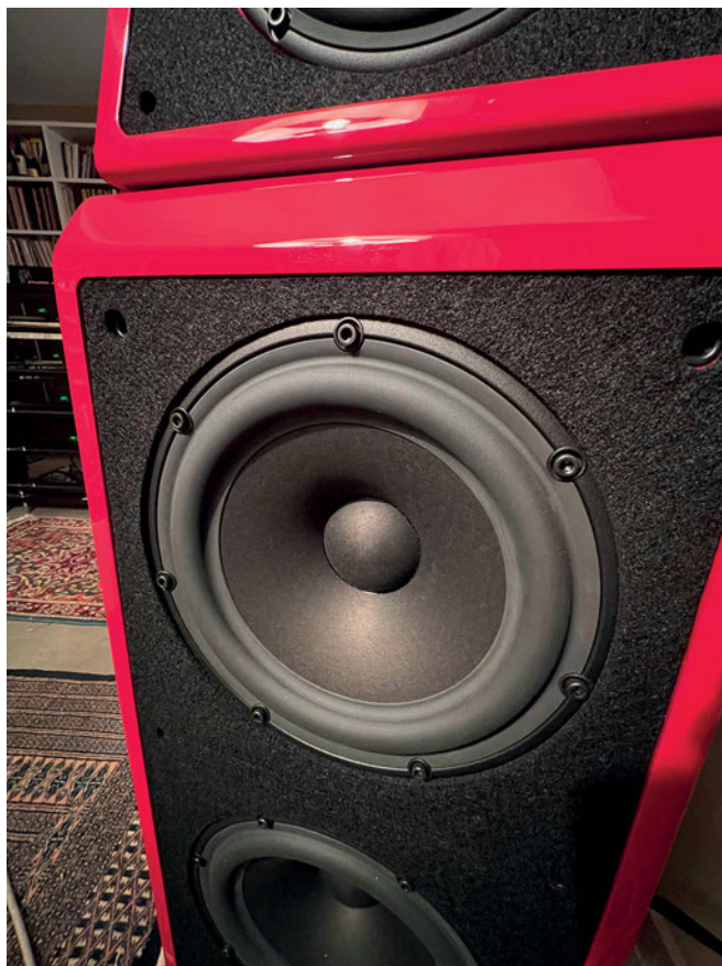
Dettaglio del woofer in cellulosa da 29 cm, ereditato dal modello Sasha.
