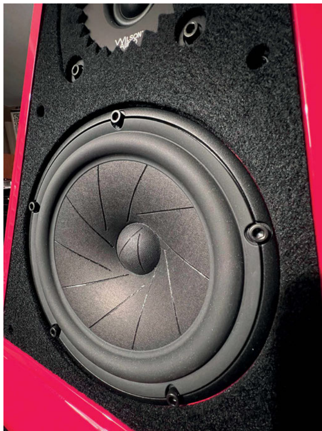
Particolare irrigidimento della membrana del mix da 18 cm in cellulosa.
